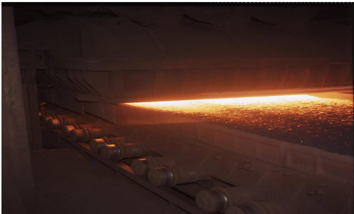
Obr.3: Zapalovací hlava, začátek spékacího procesu (Foto archiv Vítkovice)
