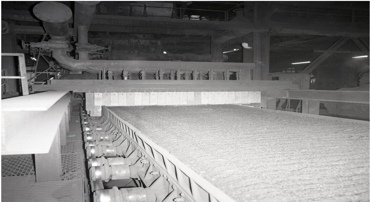
Obr.4: Aglomerát na spékacím pásu, horní vrstva je už spečena (Foto archiv Vítkovice)
